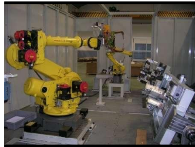
Cabina de soldadura automática
