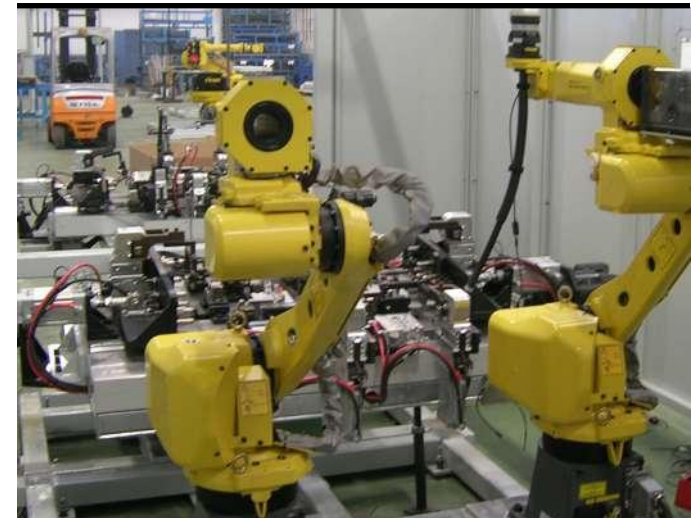
Detalles: Fabricación de una cabina de soldadura
