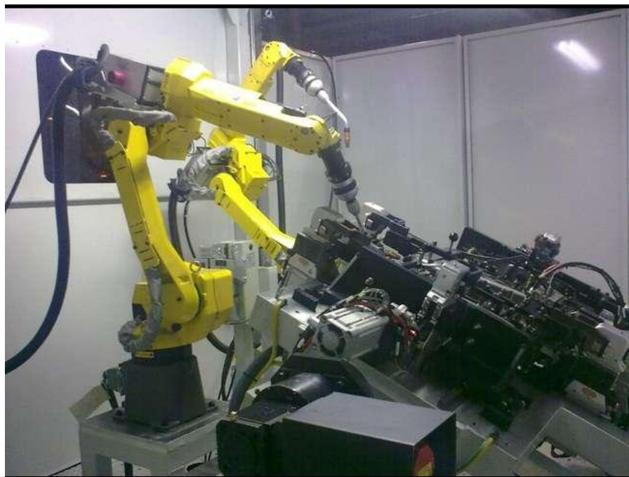
Vista parcial de una cabina de soldadura MIG (soldadura con gas inerte)
