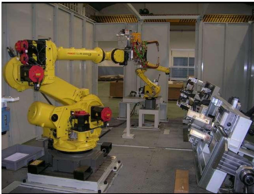
Cabina de soldadura automática
